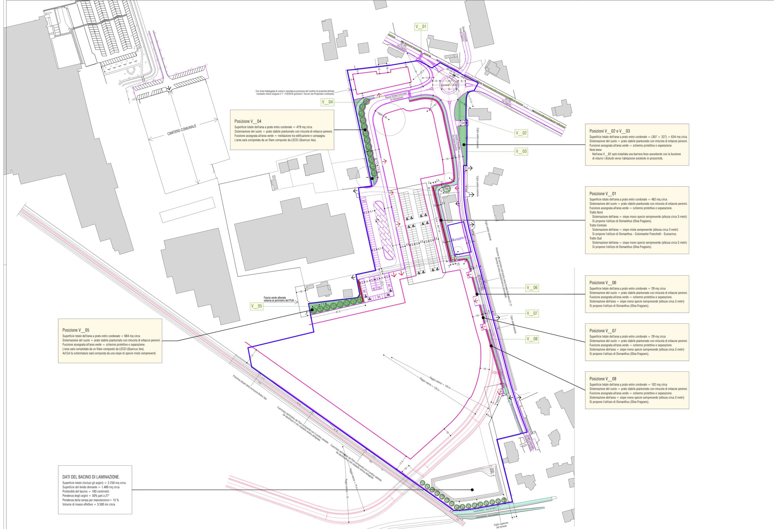
Con linea tratteggiata di colore è riportata la posizione del confine di proprietà definita mediante rilievo eseguito il 11/10/2018 (presenti i Tecnici dei Proprietari confinanti)
